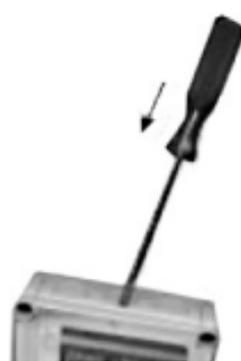
**Рис. 1.** Пробивка отверстия
