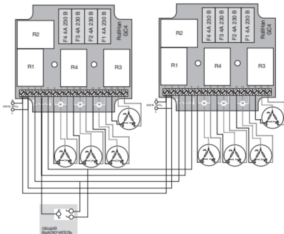
Рис. 3. Схема соединений блоков GC4
